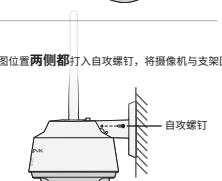
(2) 将摄像机按照下图方向推入已固定的支架，推到底。(3) 在下图位置两侧都打入自攻螺钉，将摄像机与支架固定。
